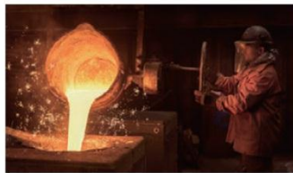
图3-4 钢水注入模具前，模具必须干燥
