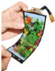
图2 一物利用有机发光材料制造的显示屏
