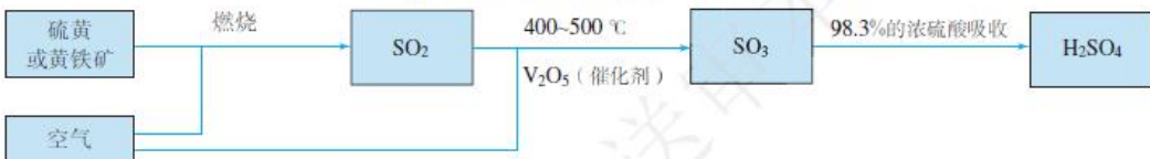
图 5-4 工业制硫酸的原理示意图
