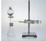
图 2-1 测定锌与硫酸反应速率的装置
