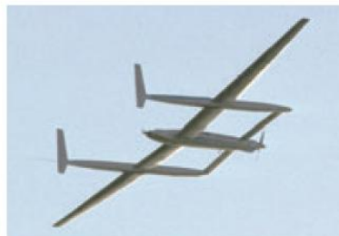
图 5-10 使用了芳纶纤维结构材料的轻型飞机
