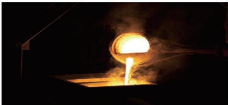
图3-4 钢水注入干燥的模具
