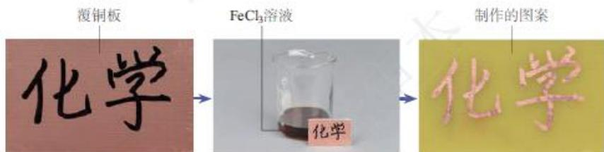
图3-12 利用覆铜板制作图案
