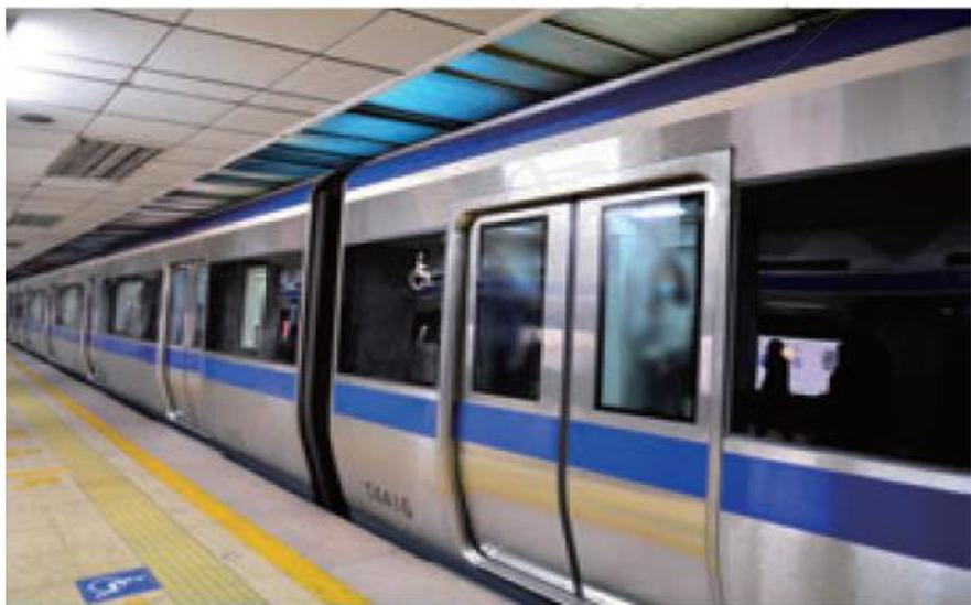
图3-15 用不锈钢制造的地铁列车
