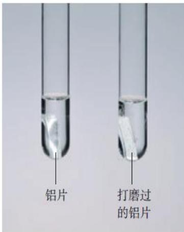
图3-17 将铝片放入NaOH溶液中
