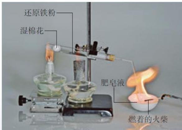
图3-5 铁粉与水蒸气反应
