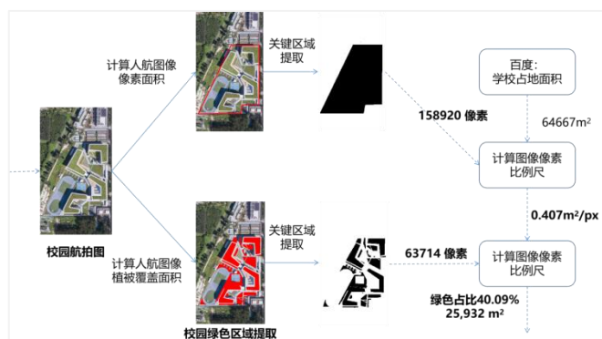
图 14 计算校园植被占地面积的操作流程
